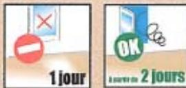
Lors du coulage, et au minimum pendant 24 heures après le coulage, le local doit rester fermé, et la chape protégée de l'ensoleillement direct. La chape est accessible un jour plein après le coulage. Pour assurer un bon séchage, le local doit être alors bien aéré, y compris en période de chauffe. Le stockage sur la chape, la ré-humidification accidentelle, un temps humide ou froid ralentissent le séchage.
