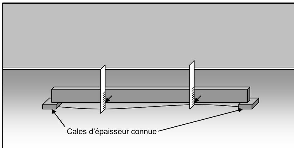
Figure 2 - Méthode de mesure des écarts de planéité
